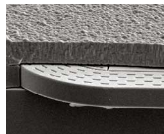
シリコンオシレータ構造例 (SiTime 殿提供)
